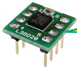
3軸ジャイロセンサーモジュール L3GD20 (3.3V I2C/SPI 仕様)
