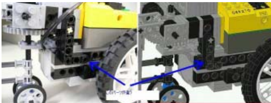
図 16 L 字ブロックによる連結
