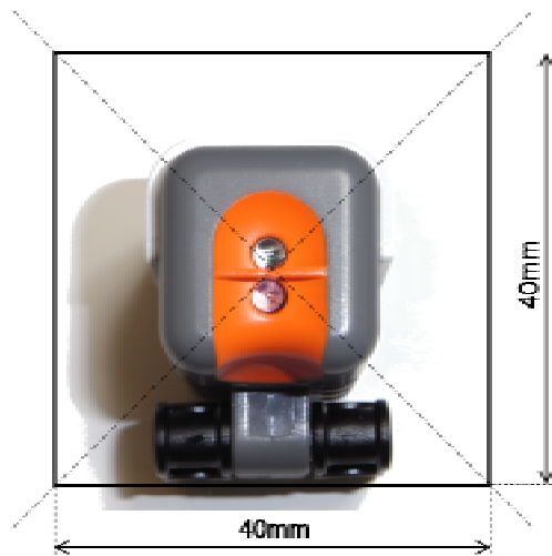
図 21 遮光スカートの大きさ制限
