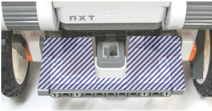
図 13 遮光スカートの大きさ制限(前部)
