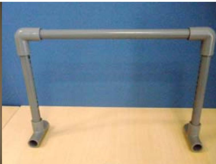
各部の接合は接着不要ですが、競技時には、転倒時のずれを防ぐために、ビニールテープなどで、接合部を補強してください
