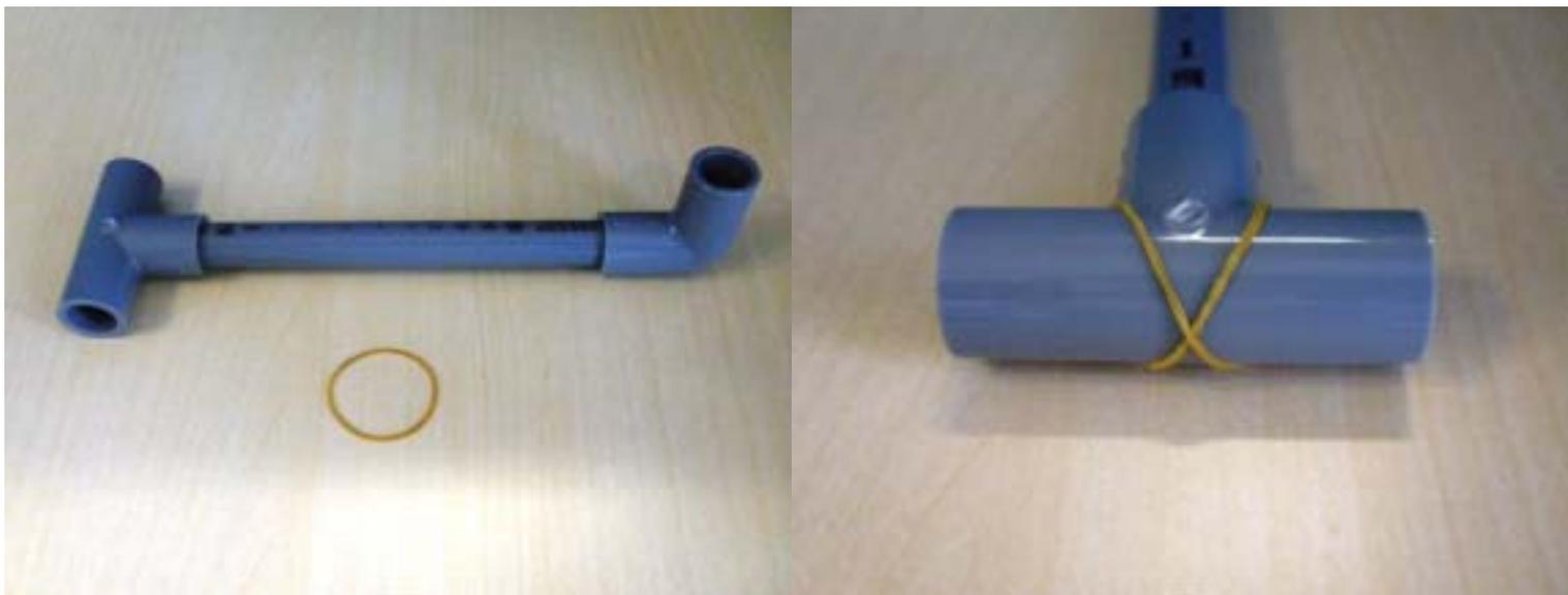
接地部分に図のように輪ゴムを巻いて、滑り止めにします
