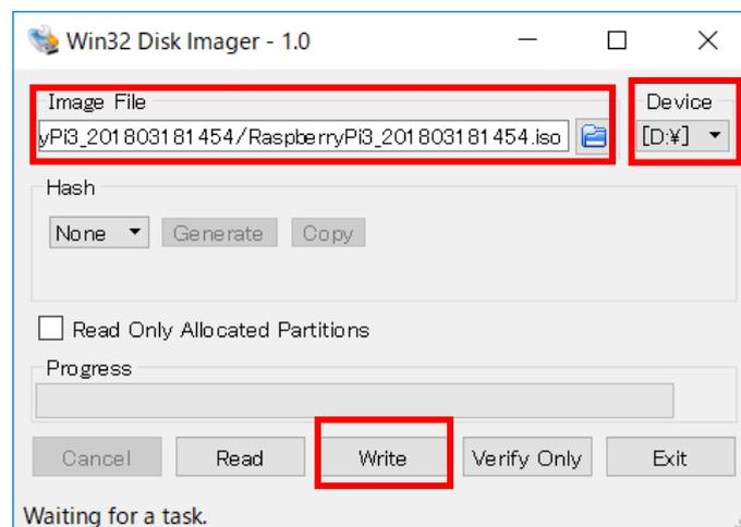
4. 書き込み完了後、SD カードを Raspberry Pi3 にセットします。
